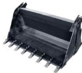
Zum Verladen von Schüttgütern, Aushub und Planieren, mit zusätzlicher Greiffunktion
